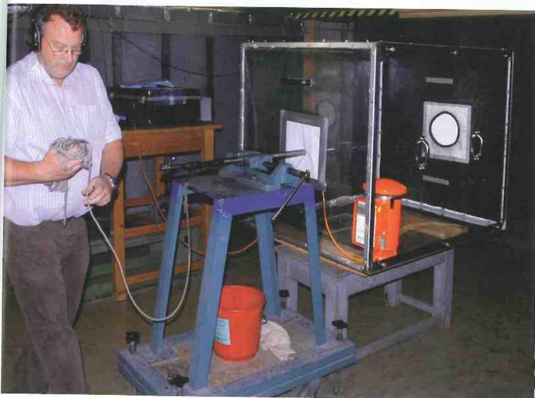
Der Versuchsaufbau: Ein Plexiglastasten mit Staubsammler fängt mit einem Filter Blei und Schwermetall-Partikel auf; die Auswertung des Filters erfolgt dann im Labor. Der Testlauf wird durch einen Seilzug ausgelöst. Die geringen Schadstoff-Werte der Cineshot verdankt die Patrone dem bleifreien Zündhütchen. Das Geschöß besteht aus einem Bleikern im Stahlmantel und ist verzinkt.
